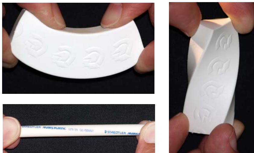
Figura. 1. Simulación de solicitaciones utilizando una goma de borrar.
